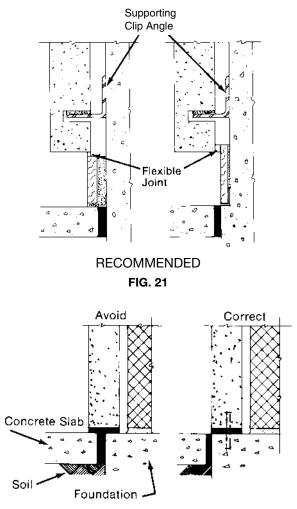
EXPANSION JOINT OVER CONCRETE SLAB FIG. 22
