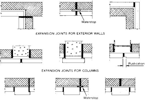
EXPANSION JOINTS FOR PILASTERS
