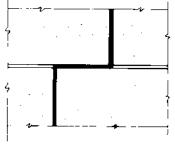
VERTICAL EXPANSION JOINT WITH HORIZONTAL OFFSET
